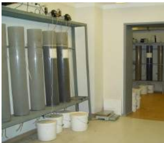
Рис. 1. Колонны с рудой
