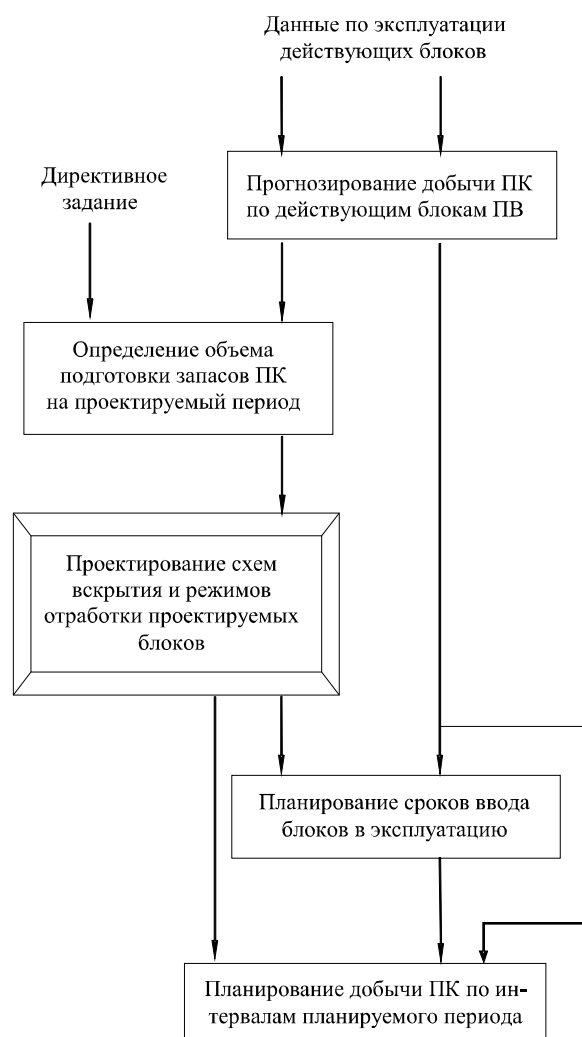
Рис. 1. Укрупненная схема составления плана горных работ для предприятия подземного выщелачивания
